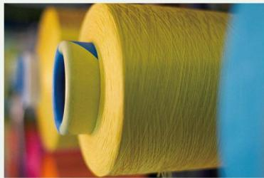
芳纶自然状态下呈现金黄色、价格昂贵、被称为“黄金丝”。与碳纤维、超高分子量聚乙烯纤维并列被称为世界三大高性能纤维。目前间位芳纶(PMIA, 1313)和对位芳纶(PPTA, 1414)两类被广泛应用，其中对位芳纶比间位芳纶具有更好的力学性能，生产技术难
